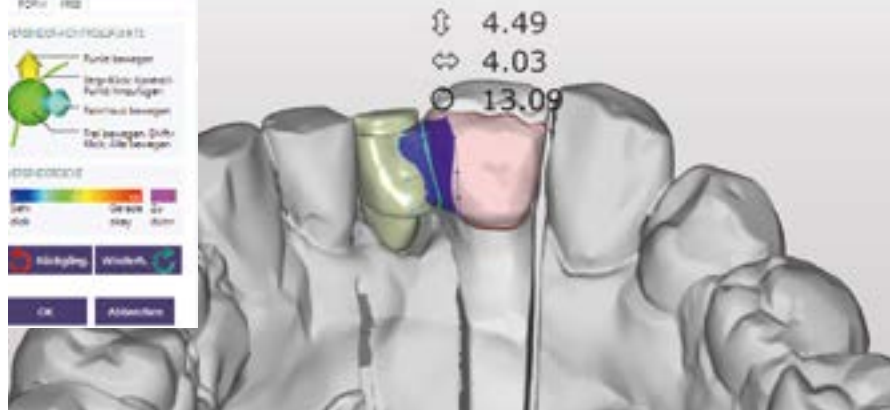
Abb. 27 (oben) Digitale Konstruktion des Zirkonoxidkeramikgerüsts (Zahn-technik und Bild: ZTM Tomonari Okawa, Hamburg)
